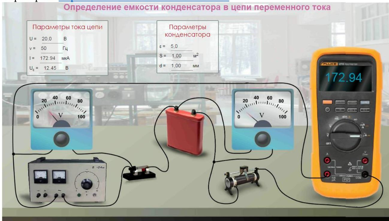
6.2. Ознакомьтесь с таблицей, заполните установочные параметры эксперимента в шаблоне отчёта согласно варианта (номер компьютера):  $U$ ,  $\nu$ ,  $\varepsilon$ ,  $S$ ,  $d$  в системе СИ.
