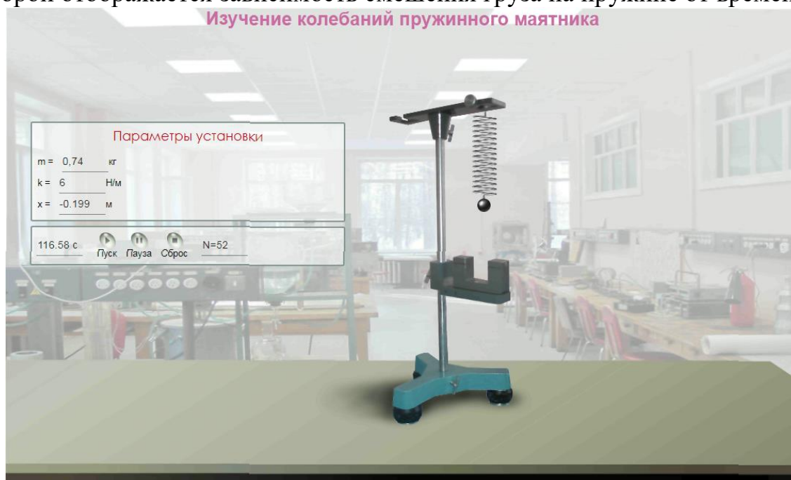
Рис. 1. Экспериментальная установка «Изучение колебаний пружинного маятника»
