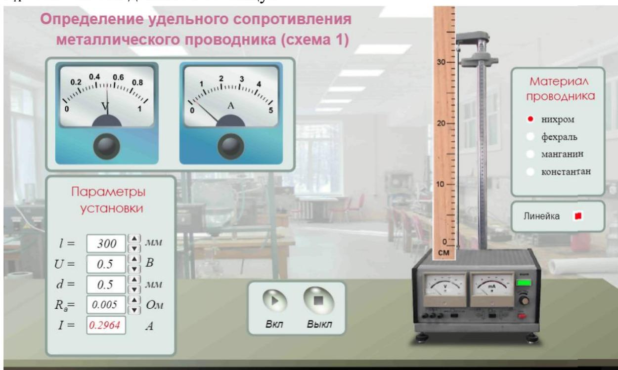
3. При помощи регулятора тока установить произвольное значение силы тока  $I_A$ . Записать в таблицу 1 соответствующее ему напряжение  $U_B$ .
