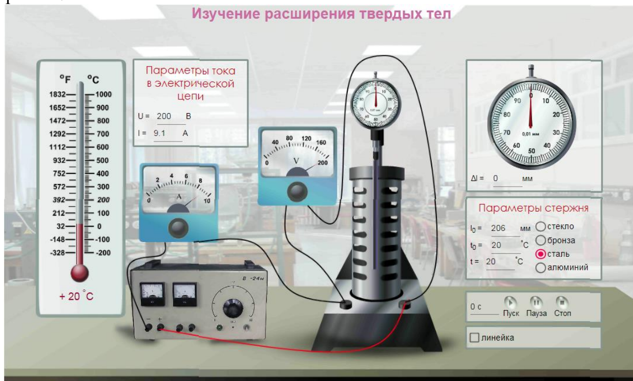
Рис. 3. Виртуальная интерактивная установка «Изучение расширения твердых тел»: http://efizika.ru/html5/29/index.html
